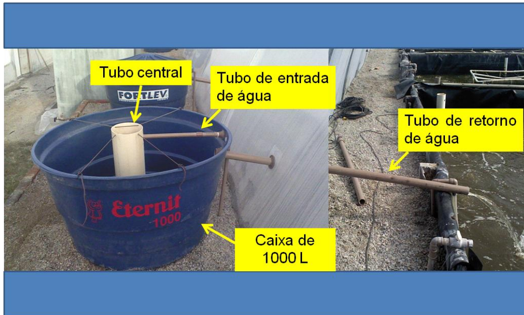
Figura 1. Clarificador montado em uma caixa de 1000 L no lado externo da estufa.
