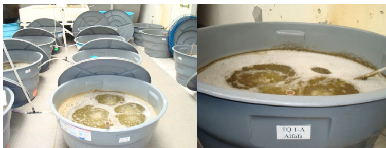
Figura 1: Unidades experimentais providas de aeração, utilizadas ao longo do cultivo super-intensivo de Litopenaeus vannamei , em sistemas de bio-flocos.
